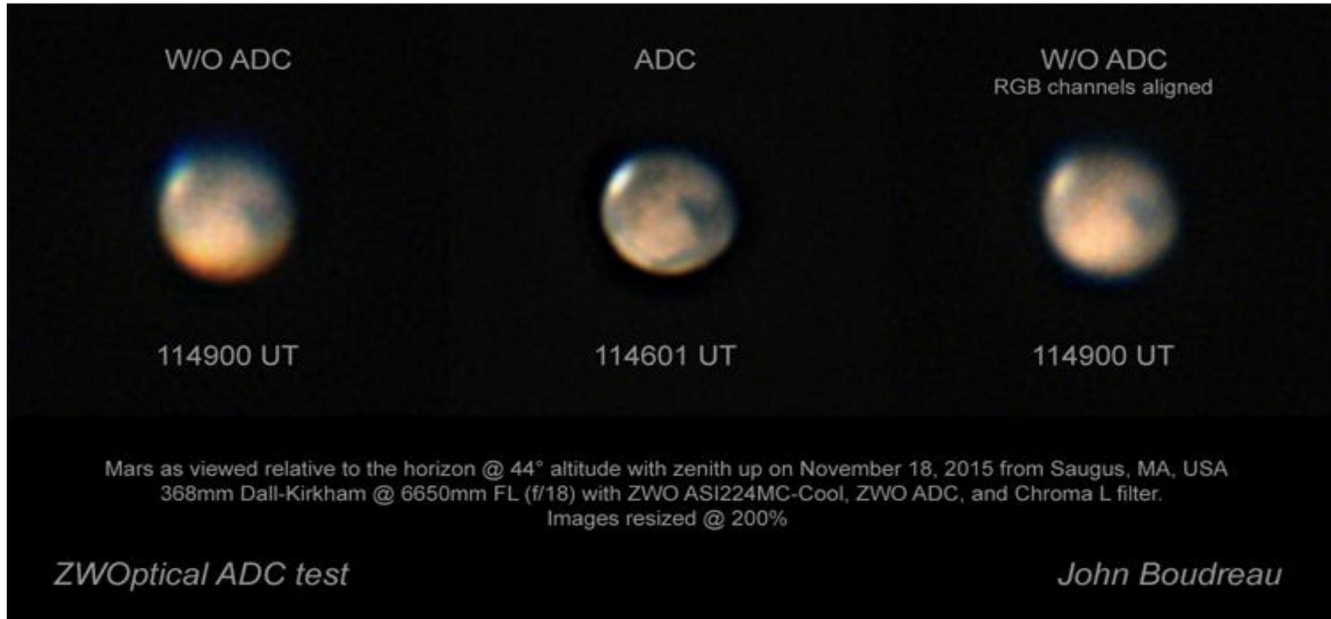
Confronto tra varie configurazioni ottiche: da sinistra verso destra, senza ADC, con ADC, e senza ADC con allineamento dei canali in elaborazione (fonte: ZWO)
