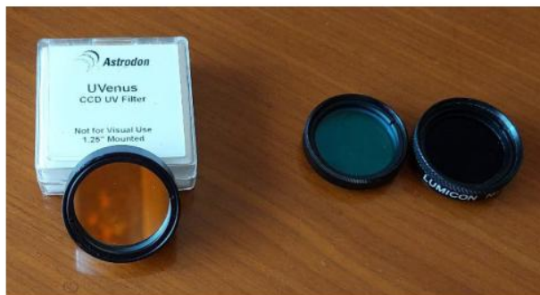
Figura 3. Un filtro ultravioletto (a sinistra) è il migliore per la ripresa delle nubi venusiane. Un'alternativa economica è costituita da un filtro violetto visuale Wratten 47 a cui viene accoppiato un taglia infrarossi (Schott BG39, celeste).
